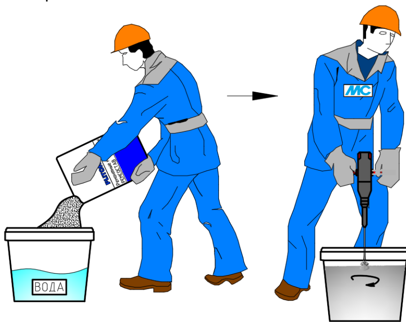
Рис.2. Процесс приготовления растворной смеси.
